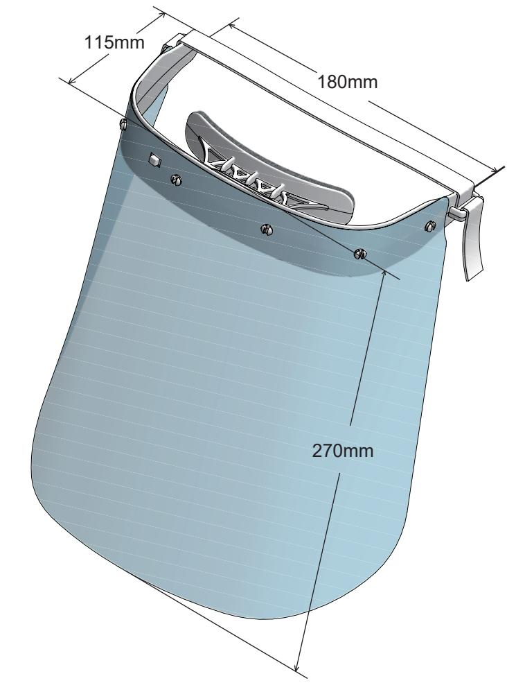
●材質：本体フレーム・帯電防止PP シールド・P E T(厚み0.2mm)
