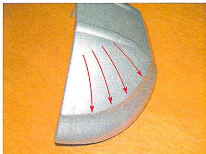
樹脂の充填方向に向かって流れ模様が発生
