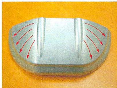
樹脂の充填方向に向かって流れ模様が発生
